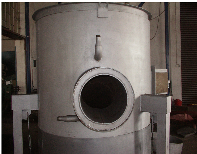
Foto 7. Przystawka przedpaleniskowa .Widok od strony wylotu dyszy.
